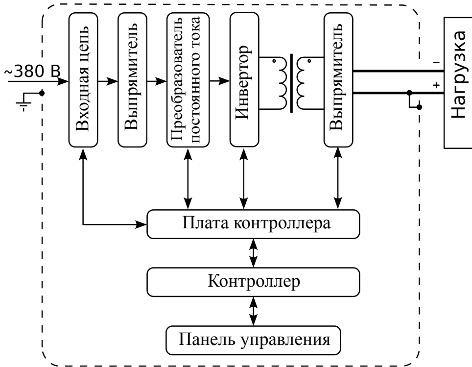
Рис. 1 — Структурная схема APEL-IS-3500-N.
