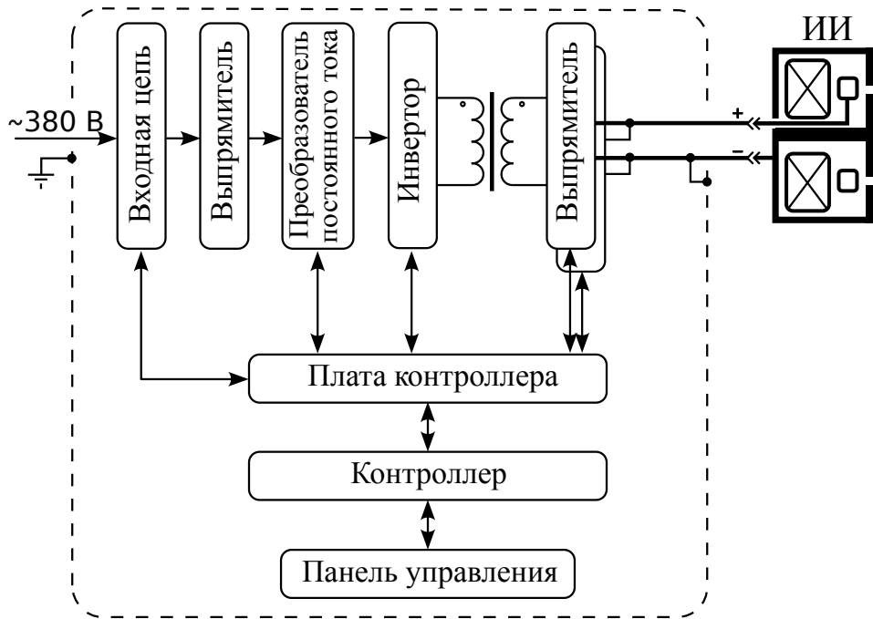
Рис. 1 — Структурная схема APEL-IS-4DC-5000.
