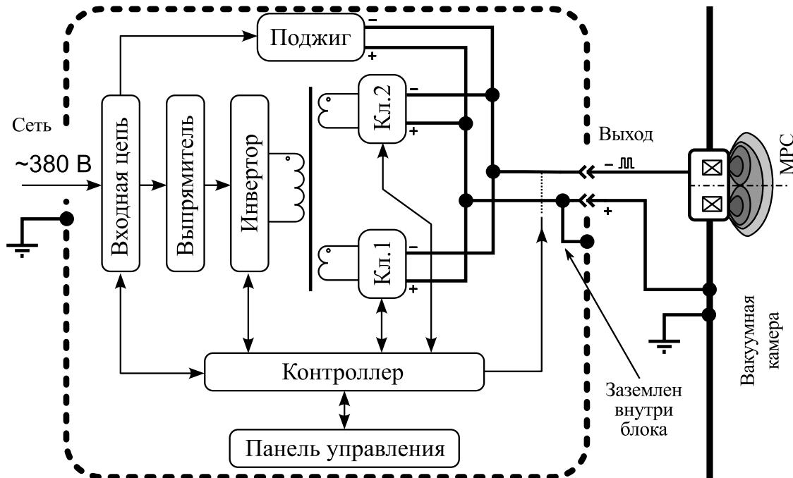
Рис. 1 — Структурная схема источника питания APEL-M-10BP-650-1.
