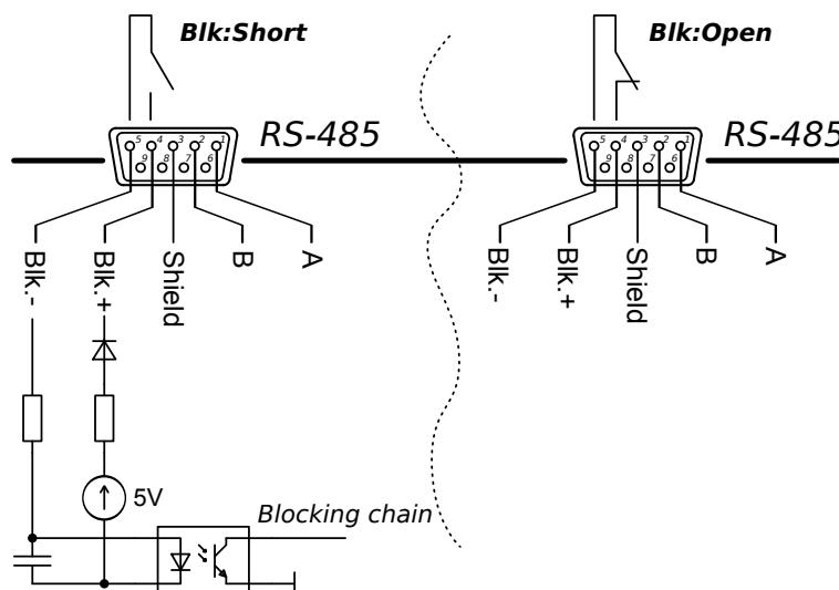
Рис. 1 — Схема цепи блокировки APEL-M-10BP-650-1.
