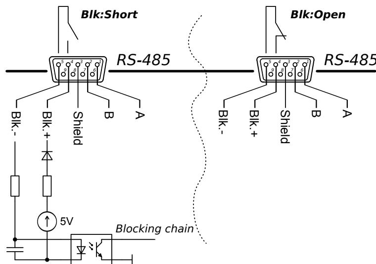
Рис. 1 — Схема цепи блокировки APEL-M-10BP-800-3.
