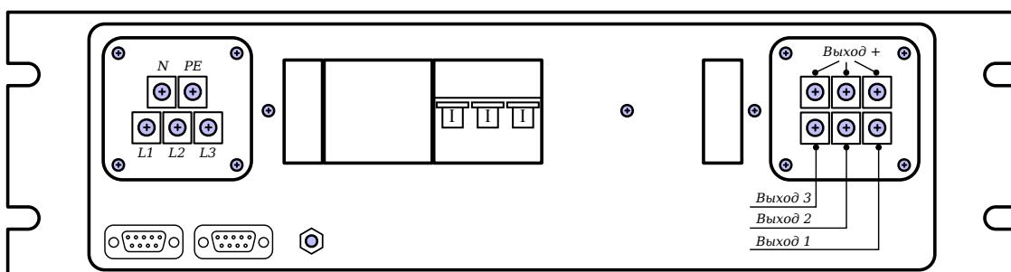
Рис. 3 — Задняя панель ИП АРЕЛ-М-10ВР-800-3.
