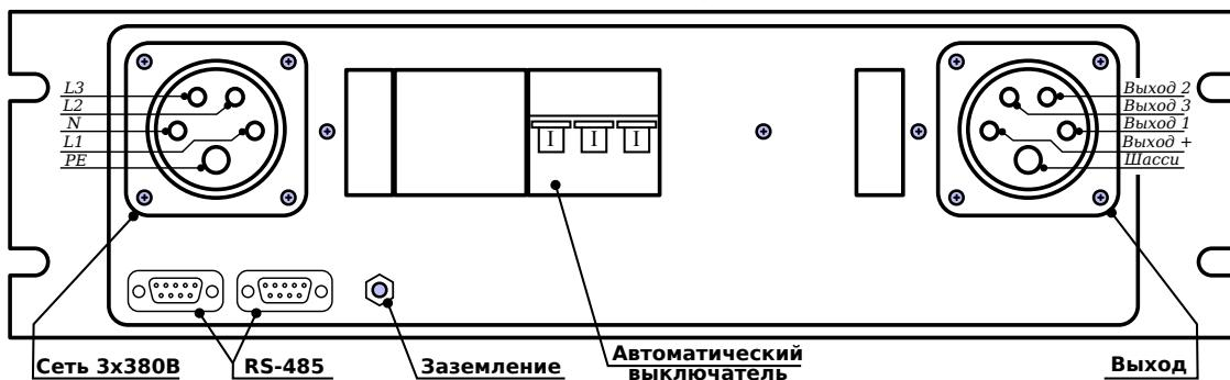
**Вариант поставки с клеммной колодкой и разъемами 7/16**
