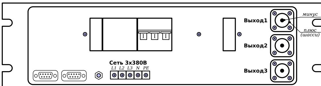
**Вариант поставки с клеммными колодками**
