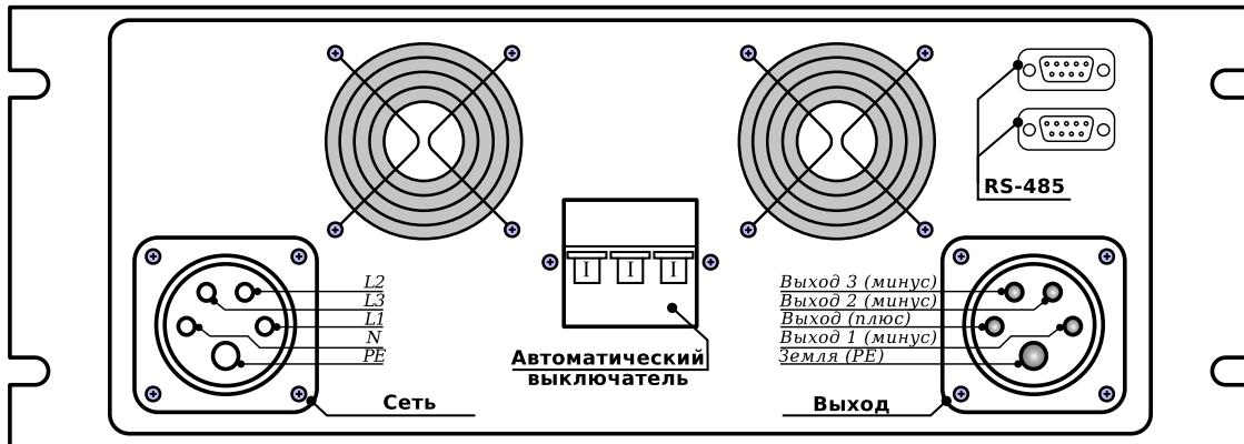
Рис. 3 — Задняя панель ИП APEL-M-12BP-1000-3.
