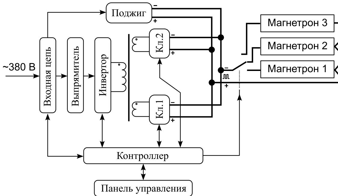
**Рис. 1 — Структурная схема источника питания APEL-M-12BP-1000-3.**
