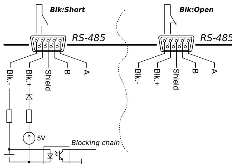
Рис. 1 — Схема цепи блокировки APEL-M-12BP-1000-3.
