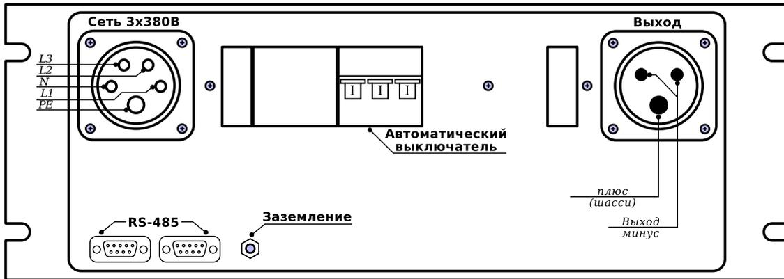
Рис. 3 — Задняя панель ИП APEL-M-12PDC-800-1.
