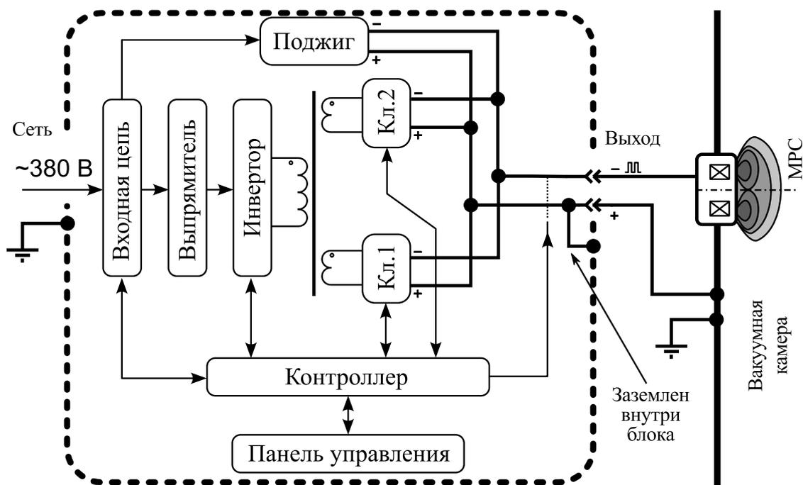
Рис. 1 — Структурная схема источника питания APEL-M-12PDC-800-1.
