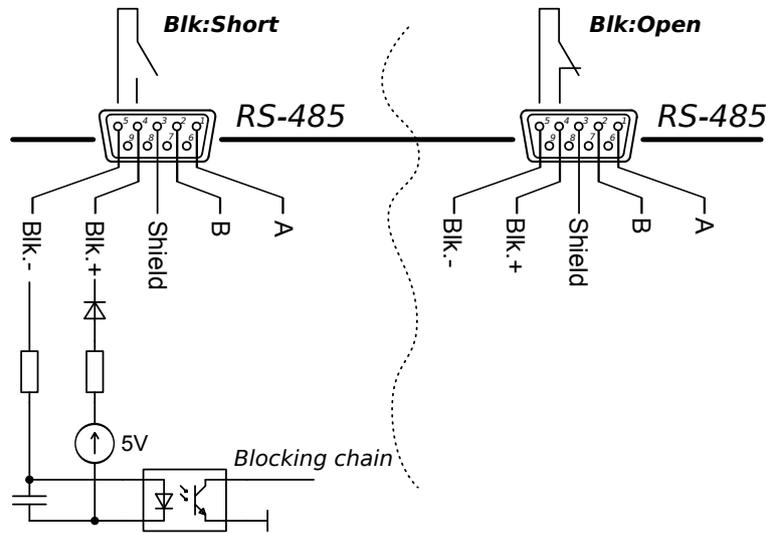
Рис. 1 — Схема цепи блокировки APEL-M-12PDC-800-1.
