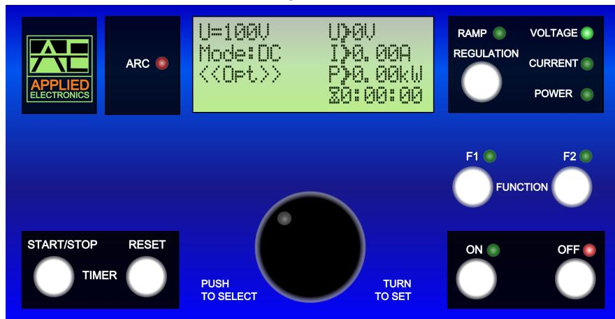
Рис. 2 — Панель управления ИП
