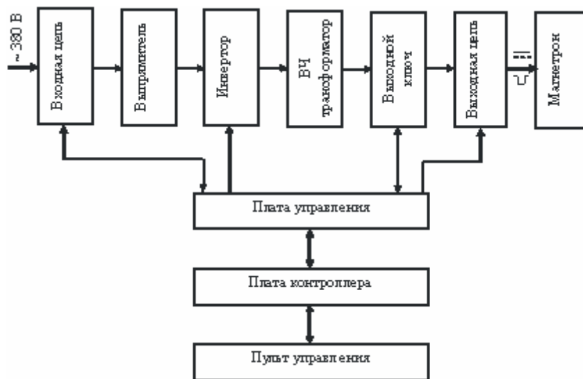
Рис. 1 Блок-схема источника питания APEL-SB-650-12
