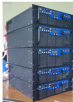
Рис. 6. Внешний вид и основные параметры ГСП HIPIMS+MFMS+BIAS
