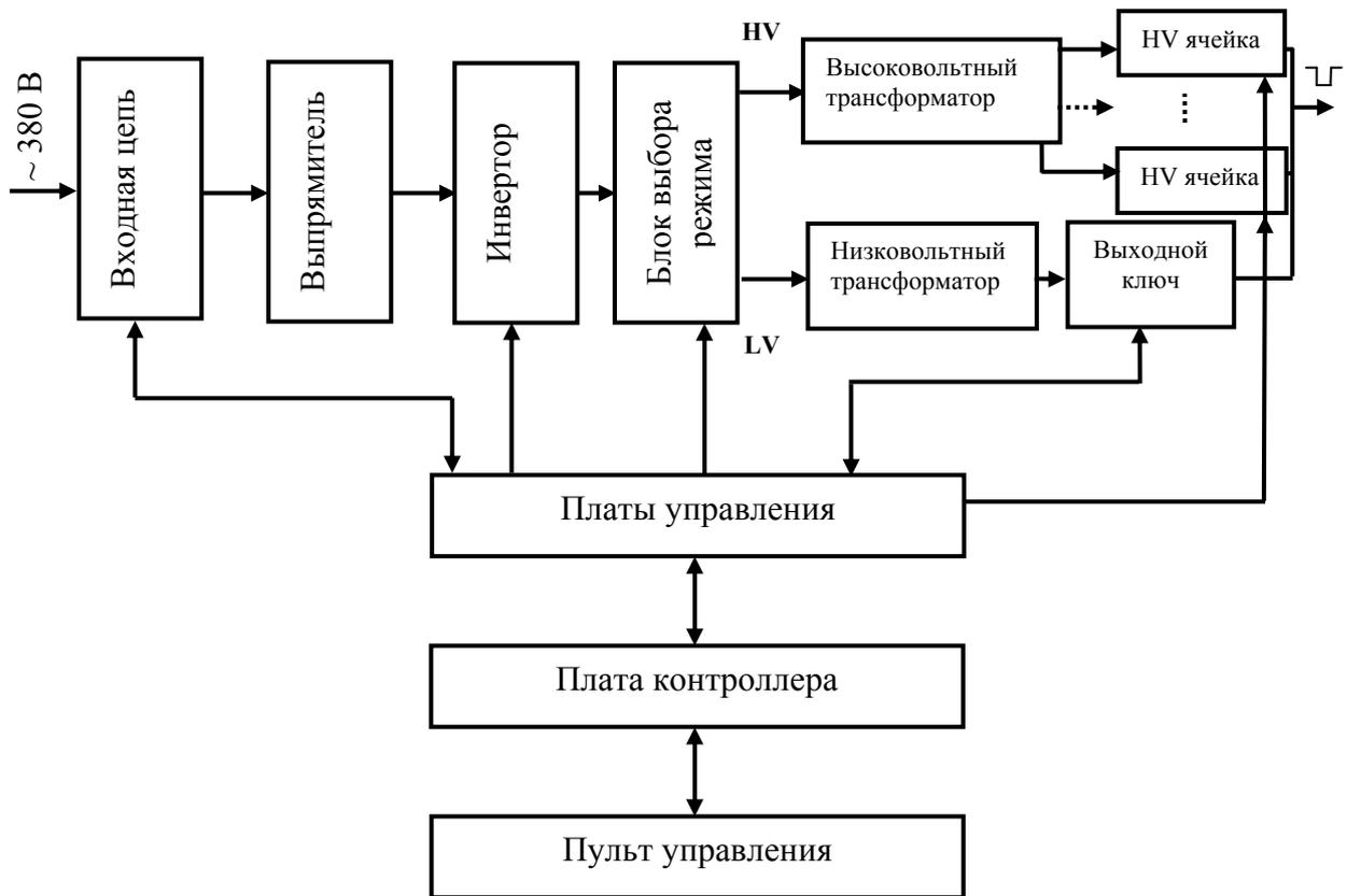
Рис. 5.11. Блок-схема источника питания смещения подложки.
