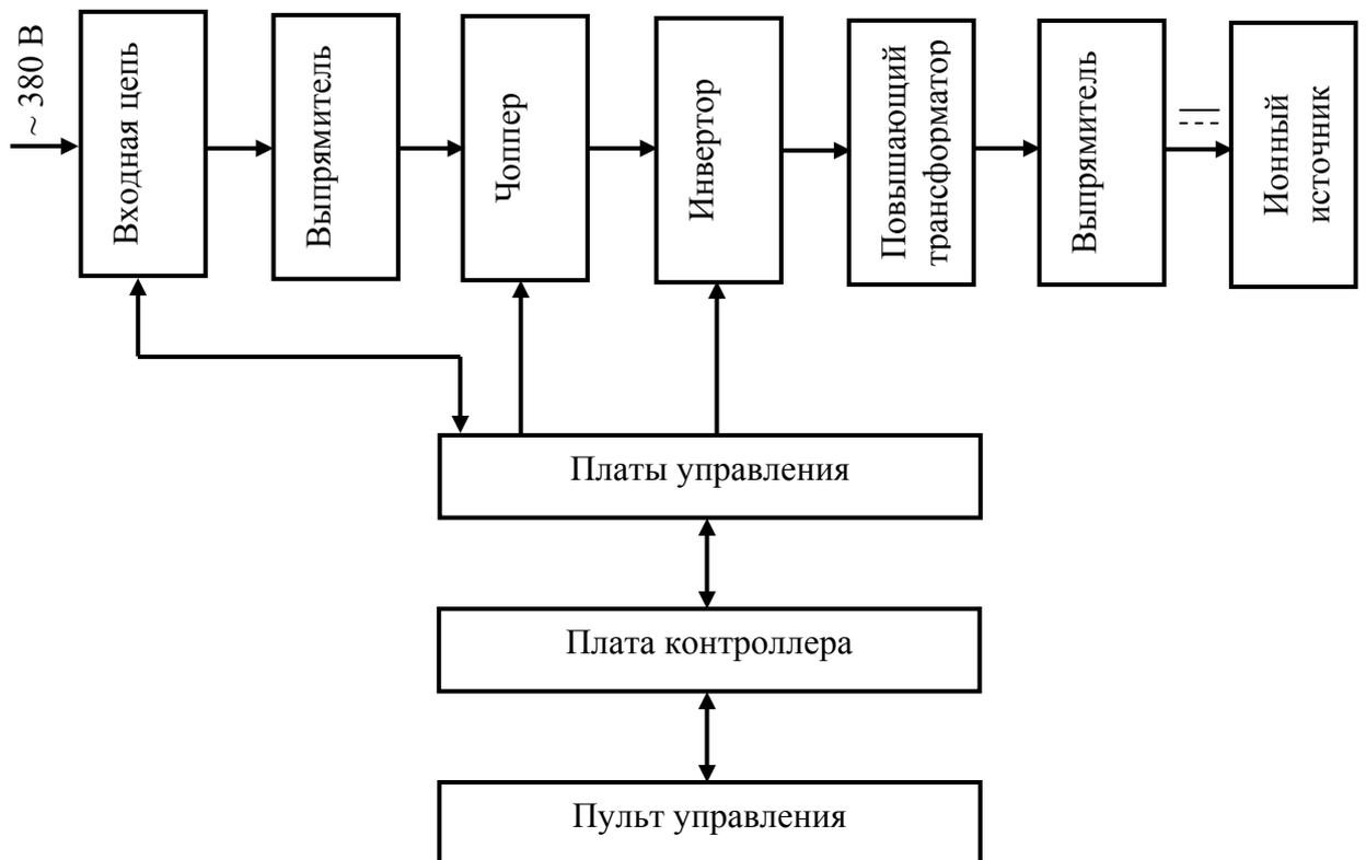
Рис. 5.10. Блок-схема источника питания ионных источников с анодным слоем.
