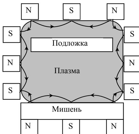
Рис.1.3. МРС с магнитной изоляцией стенок вакуумной камеры
