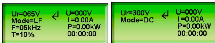
Рис.3 ЖКИ-дисплей при работе ИП в импульсном (справа) и постоянном (слева) режимах
