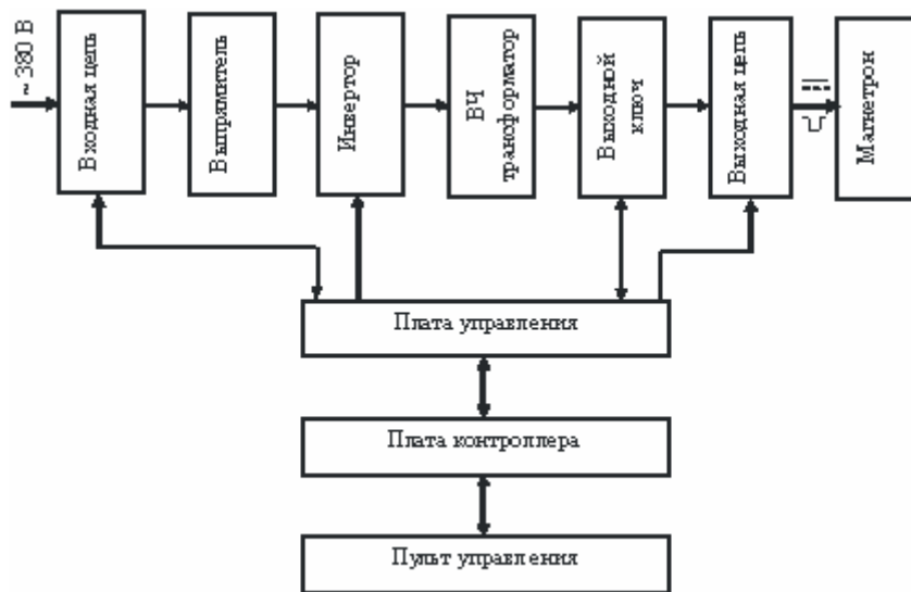
Рис. 1. Блок-схема источника питания APEL-M-5DC
