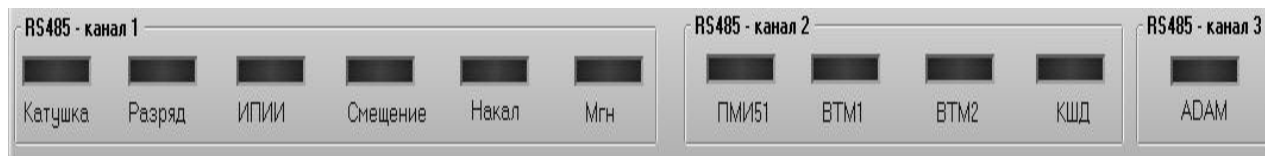
Рис. 27. Индикаторы наличия связи по интерфейсу RS485 в разных каналах.
